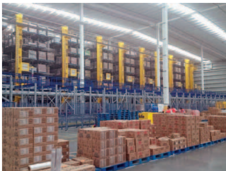
Durch das optimale Zusammenwirken von Materialflusssteuerung, Fördertechnik und Regalbediengeräten wird ein Durchsatz von 250 Paletten pro Stunde erreicht.
